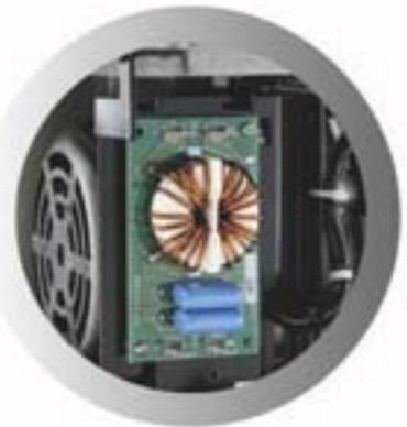
วงจรกรองสัญญาณรบกวน แยกออกจากแผงวงจรหลัก
